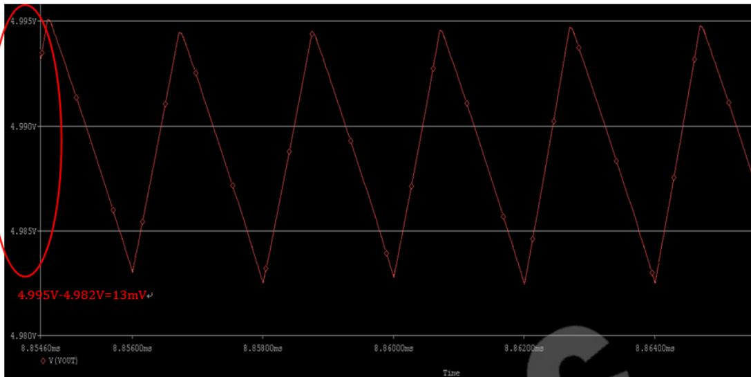
$PSRR=20*\log(1V/13mV)=37dB$ 。可见两者的差距还是比较大的。开关电源的纹波状况的确比较恶劣。
